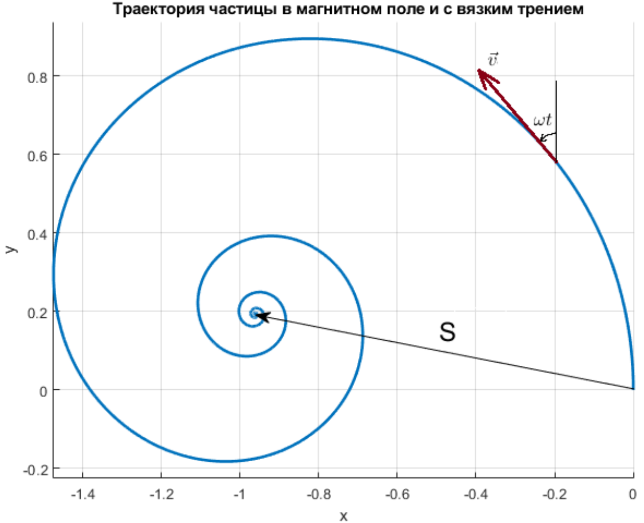
Рис. 10: Характерный вид спиральной траектории частицы в магнитном поле и при воздействии на неё вязкого трения
