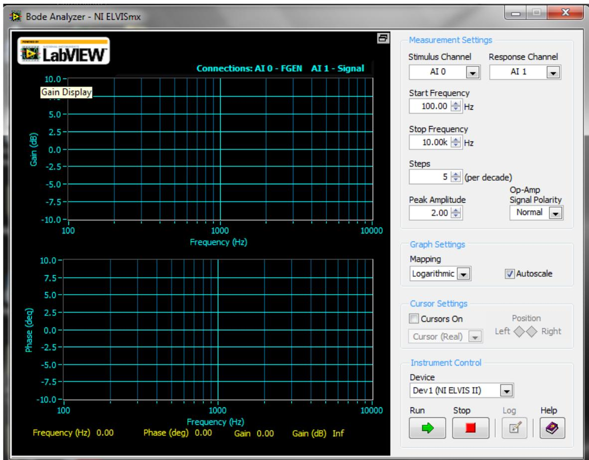
Рисунок 2.13. Окно программы измерения коэффициента пропускания схемы от частоты.
