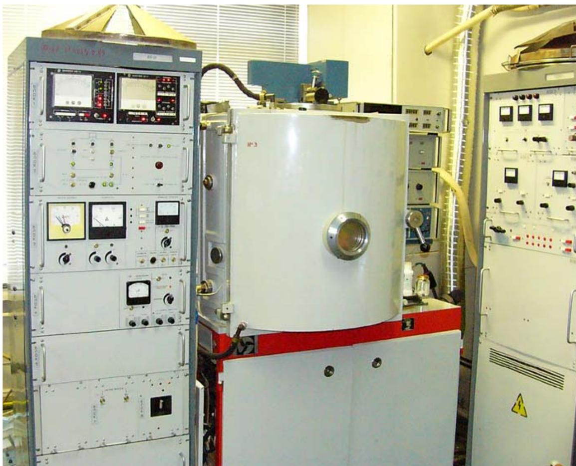
Рис. 6. Установка вакуумного напыления ВУ-1А
