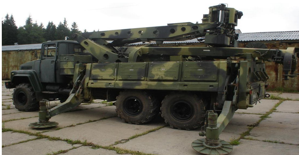
Рис. 13. Заряжающая машина ЗРС С-300 ПС (ПМ)
