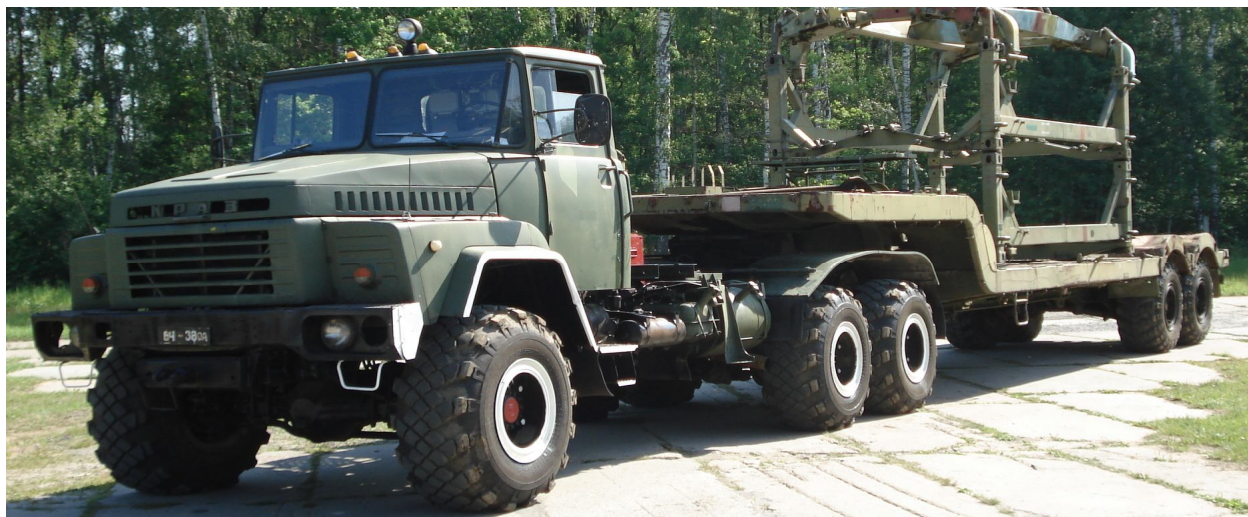
Рис. 12. Транспортная машина подстыкованная к седельному тягачу КрАЗ-260В
