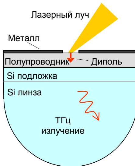
Рис. 2. Схема оптико-терагерцового преобразователя с разделением оптического и терагерцового пучков.
