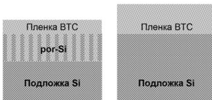
Рис.1. Схематическое изображение исследуемых структур: а) ПК/ВТС; б) Si/ВТС
