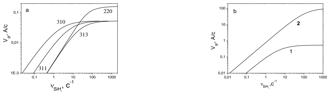
Рисунок 3. Зависимость скорости роста пленки Si от частоты распада молекул моно- (a) и дисилана (b) при P_{gas} = 0.3 \text{ мТор} , T_{gr} = 450 \text{ }^\circ\text{C} , S_{Si_2H_6} = 0.56 , S_{SiH_3} = 0.005 для разных моделей пиролиза, определяемых совокупностью индексов (jkn) и разных значений \theta_H : a) \theta_H = 0.839 ; b) \theta_H = 0.721 (1), 0.1 (2) в модели (212).
