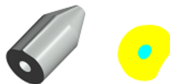
Рисунок 6 - Геометрия фильеры при наличии выпуклости на контейнере оболочки и поперечное сечение вытягиваемого волокна
