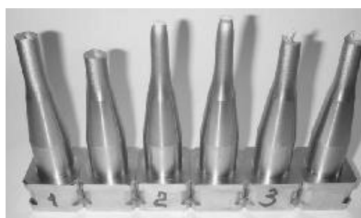
Рис. 21 Остаточные формы сплошных осесимметричных образцов при монотонном нагружении: 1 – эксперимент на кручение, 2 – эксперимент на растяжение, 3 – эксперимент на комбинированное нагружение
