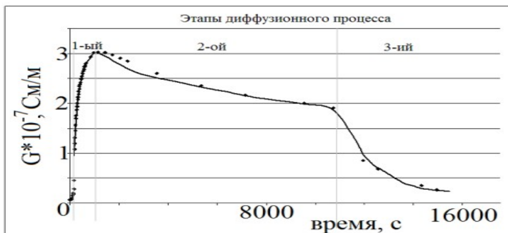
Рис. 2. Зависимость проводимости планарной ячейки с допированным фталоцианином от времени эксперимента. Точки – экспериментальные данные, сплошная линия – теоретические.
