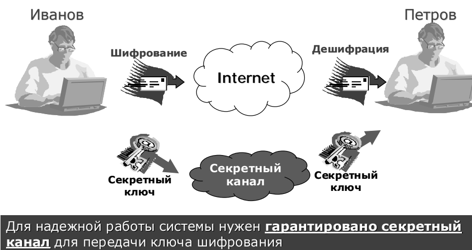
Рис. 2. Схема симметричного шифрования.
