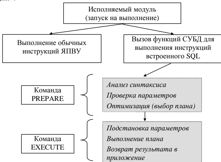
Рис. 51. Схема выполнения программы со встроенными инструкциями динамического SQL с применением двухэтапной схемы
