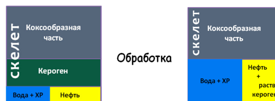
Рис. 1. Схематичный состав коллектора до и после обработки пласта химреагентом и ХР
