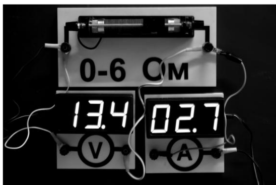
Рис. 1. Участок электрической цепи для измерения сопротивления реостата
