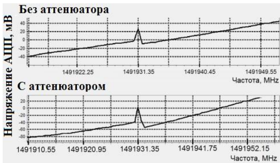
Рис. 6. Запись участка спектра поглощения HDO 1.49 ТГц при разных условиях эксперимента
