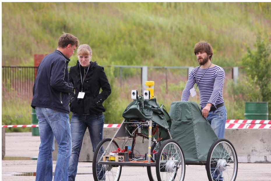
Рис. 2. Полноприводная роботизированная платформа «Лимбер», разработанная студентами физического факультета ННГУ
