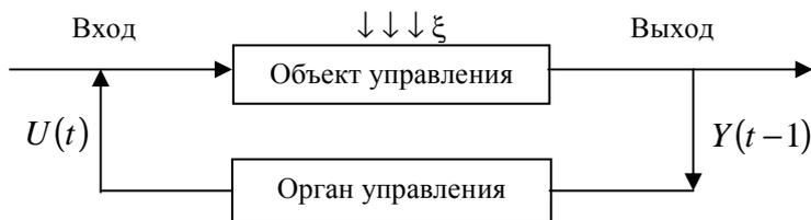
Рис. 3. Схема строения системы управления
