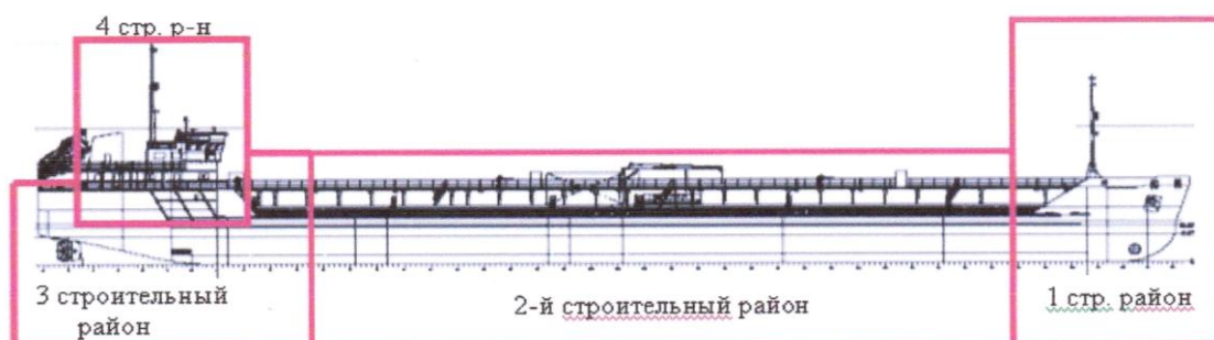
Рис. 1. Условная разбивка судна на строительные районы
