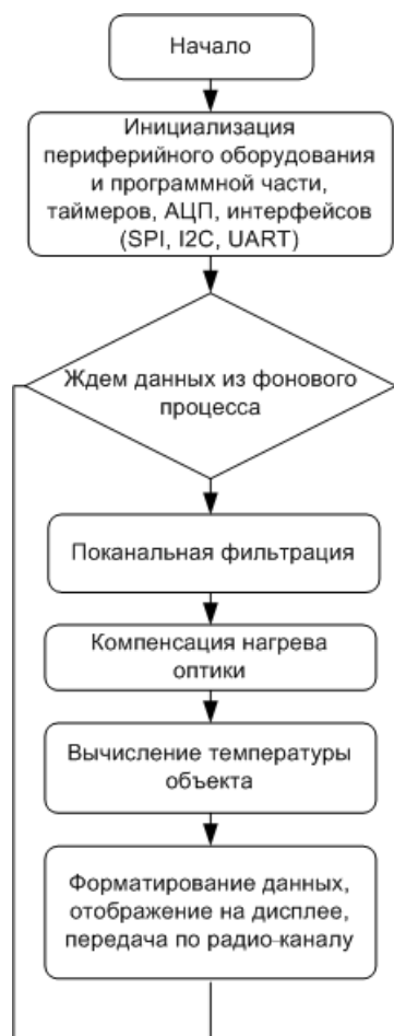
Рис. 3. Алгоритм работы основного процесса
