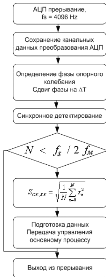
Рис. 5. Алгоритм работы фонового процесса
