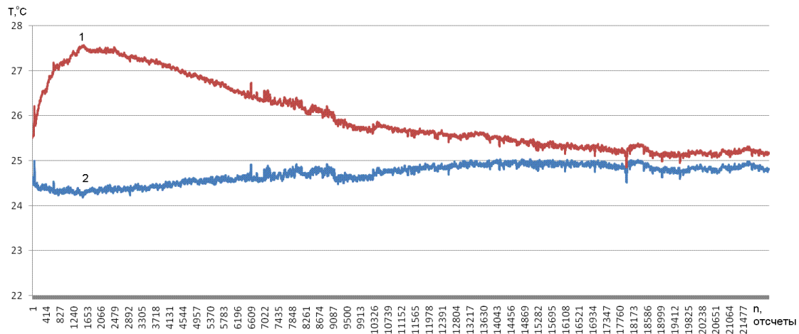
Рис. 6. Температура объекта с компенсацией дополнительным каналом (кривая 2) и без ее учета (кривая 1)
