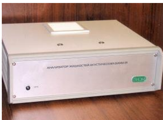
Рис. 2. Акустический безреагентный анализатор «БИОМ»
