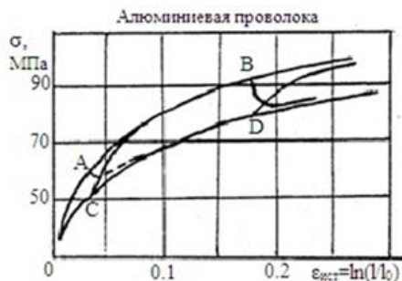
Рис. 3. Кривые деформирования сплава АД1
