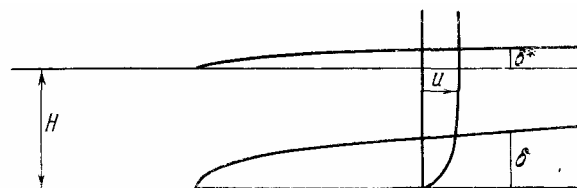
Рис. 3.2. К определению толщины пограничного слоя \delta и толщины вытеснения \delta^*
