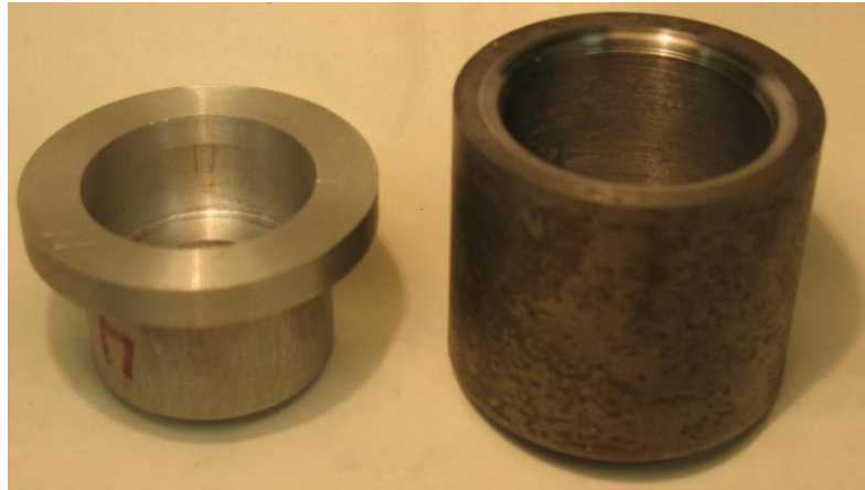
Рис. 12. Образец колпачкового типа до испытаний и передающая труба
