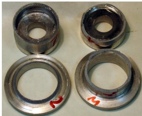
Рис.32. Образцы колпачкового типа после испытаний на растяжение
