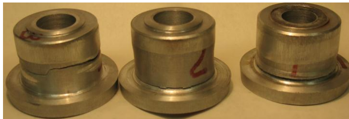
Рис.31. Образцы колпачкового типа после испытаний на растяжение
