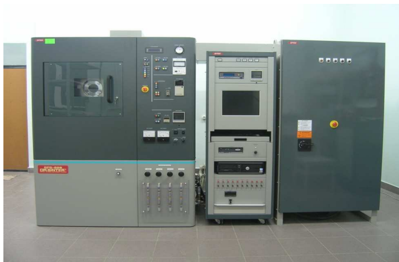
Рисунок 2. Внешний вид установки «Spark Plasma Sintering» SPS-625, SPS SYNTEX INC. Ltd, (НОЦ «Нанотехнологии» ННГУ)
