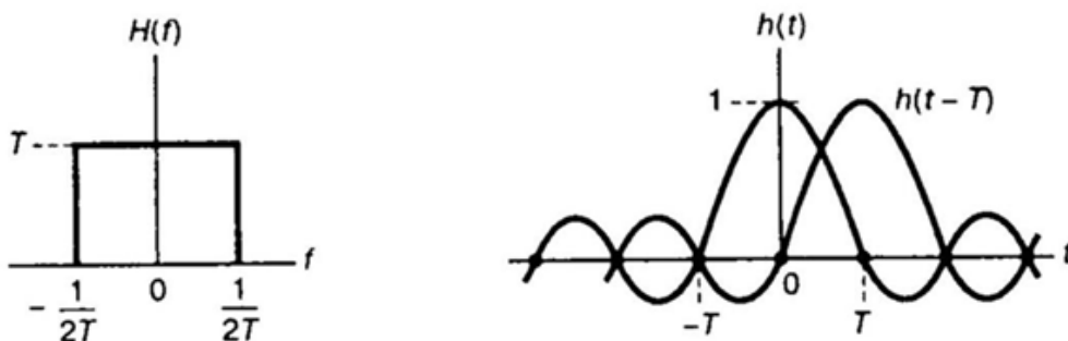
Рис. 23. АЧХ идеального фильтра Найквиста и его импульсные отклики
