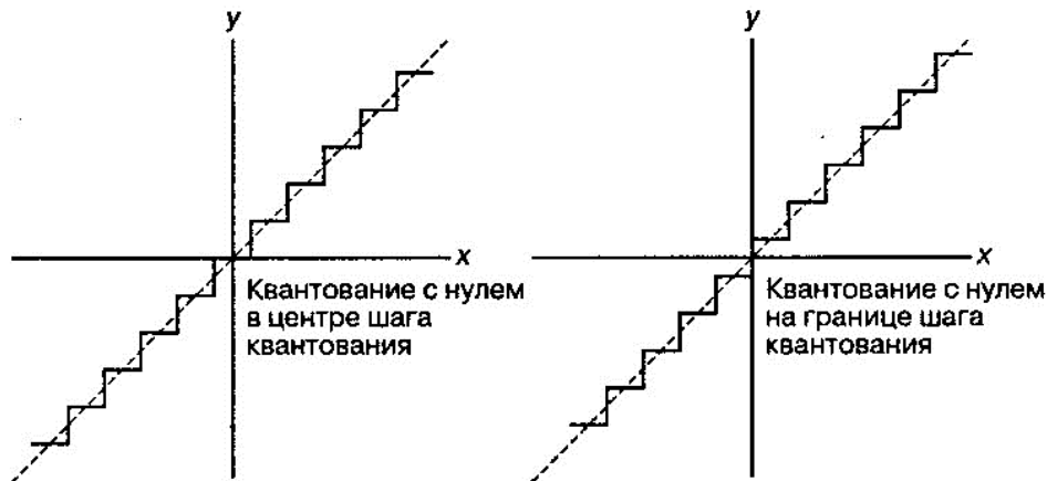
Рис. 7. Варианты проходной характеристики равномерного устройства квантования
