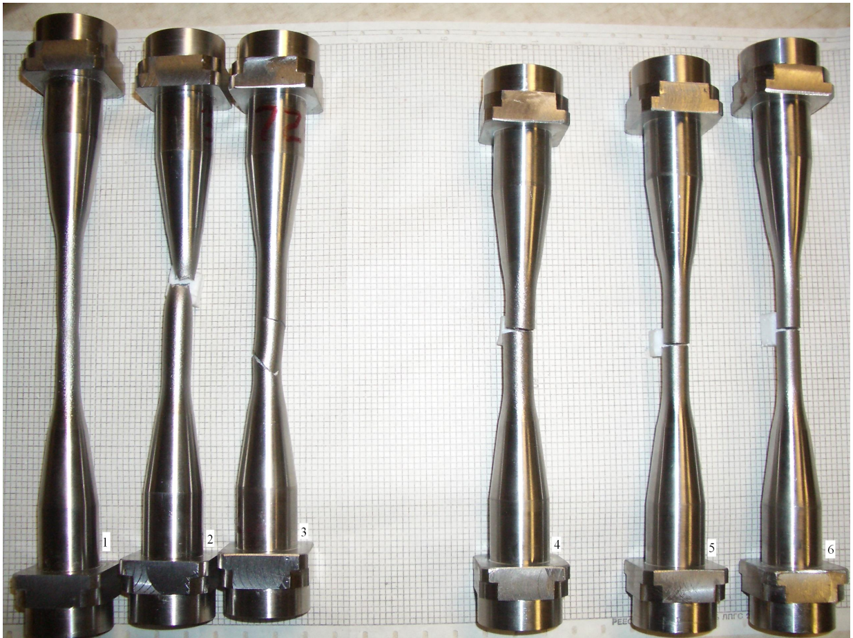
Рис. 3.16. Остаточные формы сплошных осесимметричных образцов при сложном нагружении: 1 – эксперимент на растяжение; 2, 3 – кручение и растяжение; 4 – эксперимент на кручение; 5, 6 - растяжение и кручение
