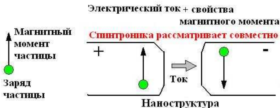
Рис.1. Иллюстрация к значению термина «Спинтроника»: в этой области физики изучаются совместные проявления свойств зарядовых и спиновых степеней свободы, т.е. синтез свойств спина (магнитного момента) и электронного переноса в твердотельных структурах.
