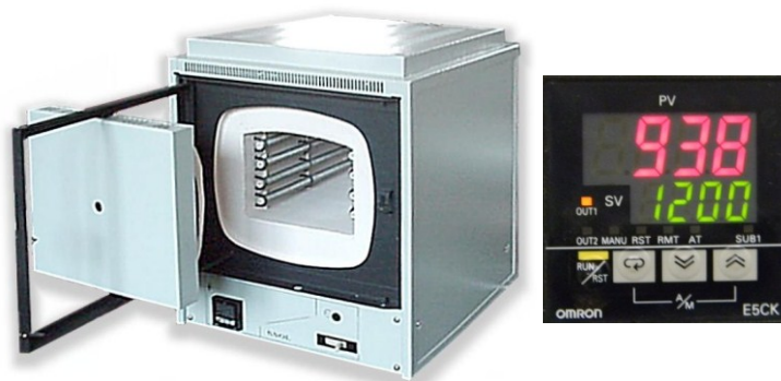
Рис. IV.2. Печь с электронным программированием Snol 6,7/1300 и ее панель управления
