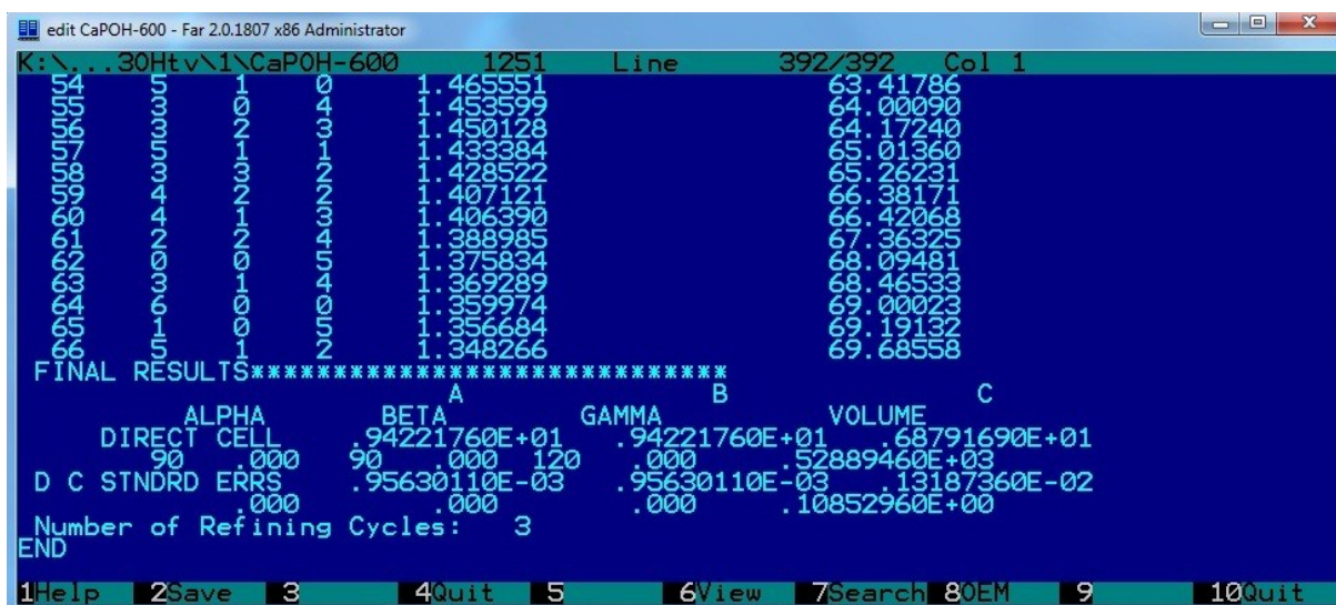
Рис. IV.17. Результаты расчета параметров элементарной ячейки в программе Indexing and least-squares powder diffraction program
