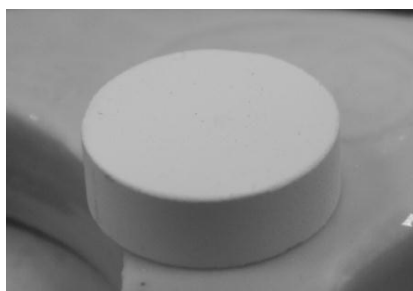
Рис. III.3. Керамика из гидроксиапатита (пороген – поливиниловый спирт)
