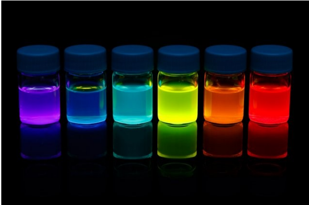
Рис. I.4. Изменение цвета (полосы испускания) коллоидного раствора частиц CdSe в оболочке CdS в зависимости от размера квантовых точек
