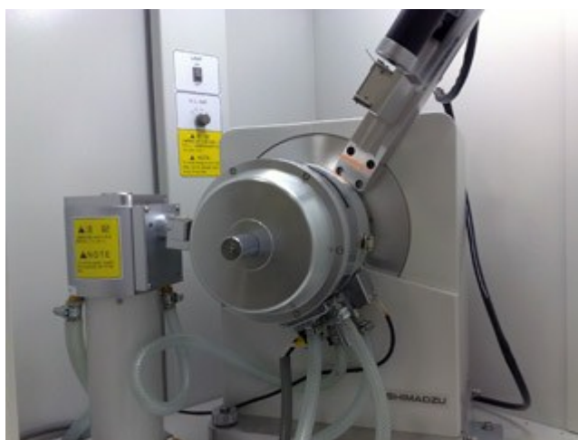
Рис. IV.33. Высокотемпературная камера HA-1001 для рентгеновского дифрактометра XRD-6000 Shimadzu
