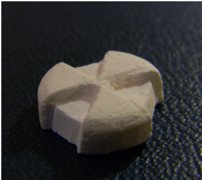
Рис. III.5. Керамика из гидроксиапатита, обработанная скальпелем
