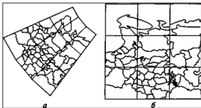
Рис.33. Кусочно-проективное преобразование: a — исходное изображение в конической проекции; b — преобразованное изображение в цилиндрической проекции
