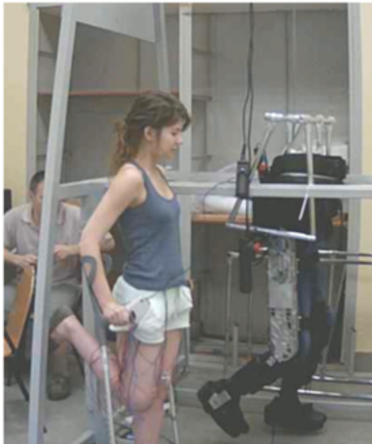
Рисунок 3 - Отработка интерфейса человек-машина на базе сигналов ЭМГ
