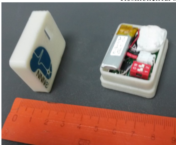
Блок регистрации, усиления и беспроводной передачи электромиографического (ЭМГ) сигнала
