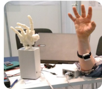
Управление макетом кисти руки (устройство копирующего типа)
