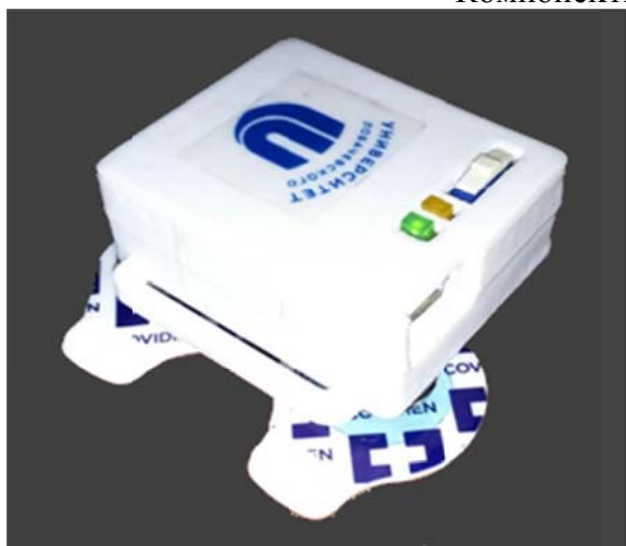
Одноканальный усилитель электромиографического (ЭМГ) сигнала
