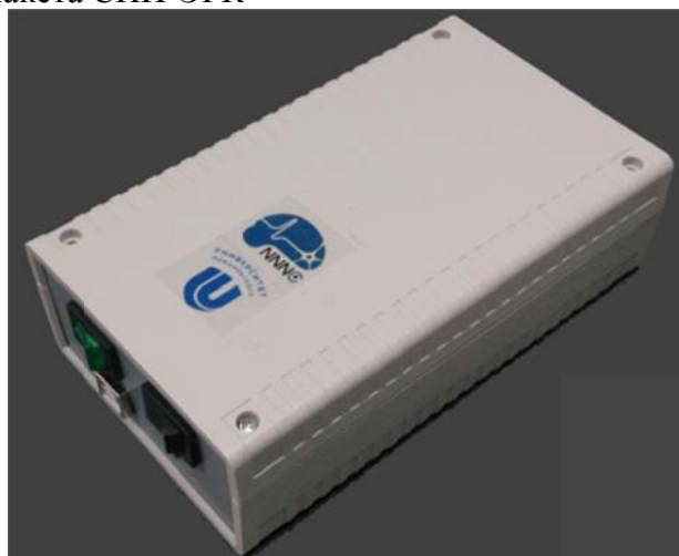
Блок приёма, обработки ЭМГ сигнала и управления исполнительными устройствами
