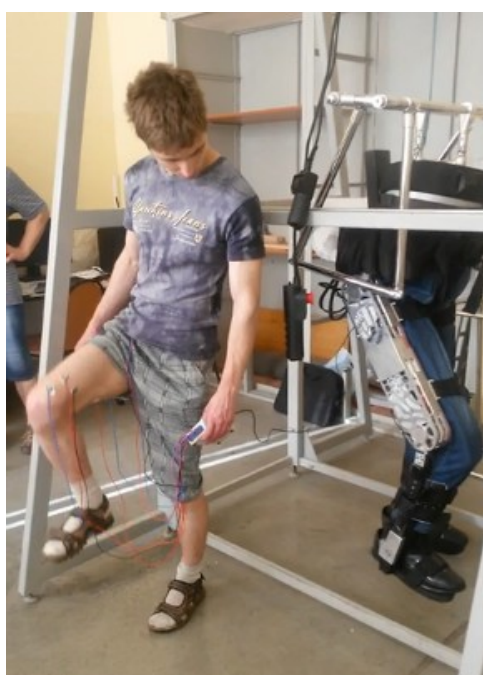
Рисунок 2. Управление экзоскелетом с помощью ЭМГ-сигнала. Блок-схема связи комплекса СРД-1 с роботом NAO.
