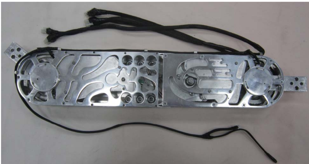
Рисунок 1 - Макет компонента ЭРК, приводящего в движение правые коленный и тазобедренный суставы ЭРК
