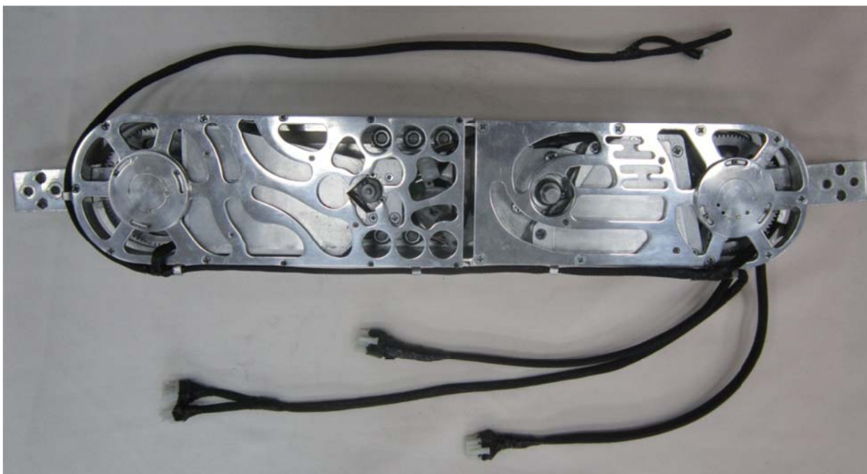
Рисунок 2 - Макет компонента ЭРК, приводящего в движение левые коленный и тазобедренный суставы ЭРК
